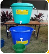
घरेलू स्तरीय फ्लोराईड रिमूवल फिल्टर
